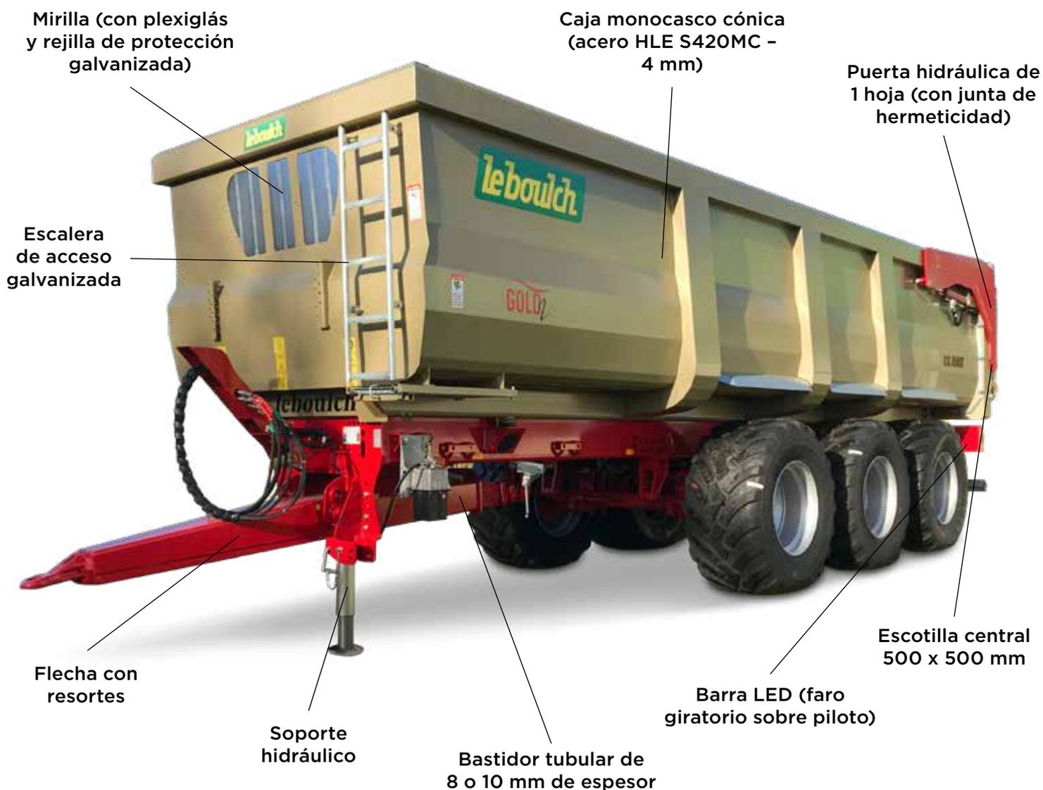
**Equipamiento específico en SEMI-ELEVADORES XXL 5800D, 6200D y 7300D (para sustituir el equipamiento de serie)**
