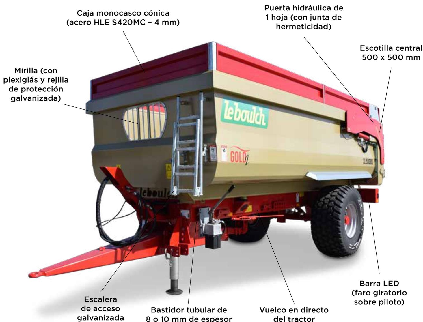
**Equipamiento específico en SEMI-ELEVADORES XL 5800D y 6200D (para sustituir el equipamiento de serie)**
